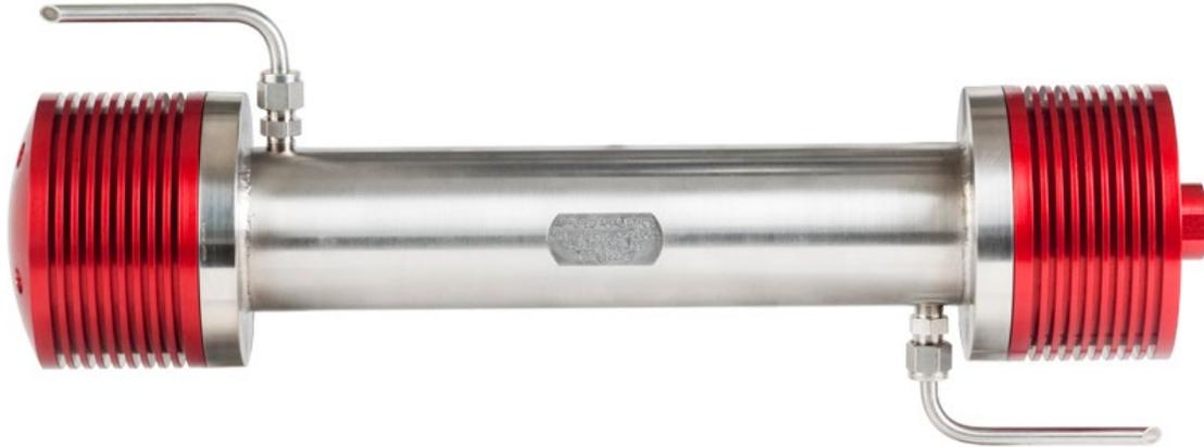
MicroSpec™ 红外光谱分析模块包括了MCP-200型号分析仪，用来连续监测能够吸收红外波段辐射的化学物质。这个坚固紧凑的设备配有短波近红外的分光光度计和一个专有设计的流通池，既可以作为系统集成部件又可以单独使用。
